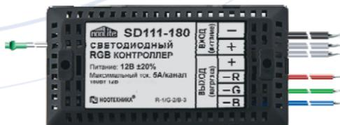
Мощность нагрузки 0–180 Вт
