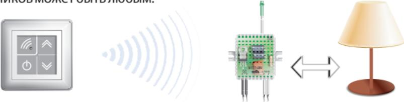
Радиопередатчики – это плоские настенные пульта (толщиной всего 10 мм), которые легко закрепляются на любой поверхности с помощью двухстороннего скотча или саморезов. В составе системы есть также пульт-брелок, который удобно брать с собой, чтобы заранее включить свет, например в прихожей, еще с улицы, и РС-адаптер, позволяющий управлять системой с компьютера, планшета или мобильного телефона.
